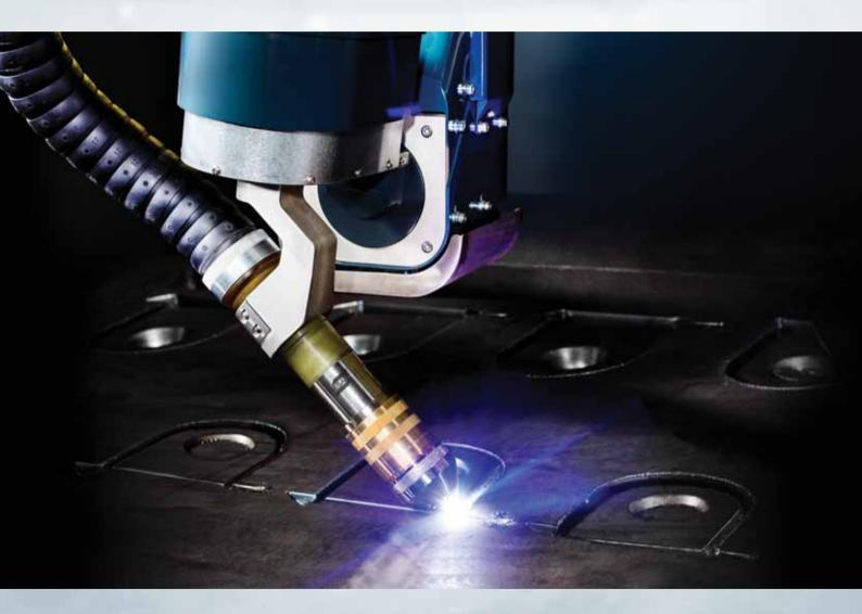
Надежная, удобная в работе, компактная система для безопасной и высококачественной плазменной резки фасок.
